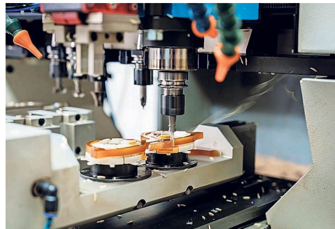
Een computergestuurde freesmachine freest het juiste model bril uit een stuk acetaat.
